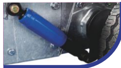
Stoßdämpfer erhöhen die Spursicherheit und den Fahrkomfort des Anhängers
